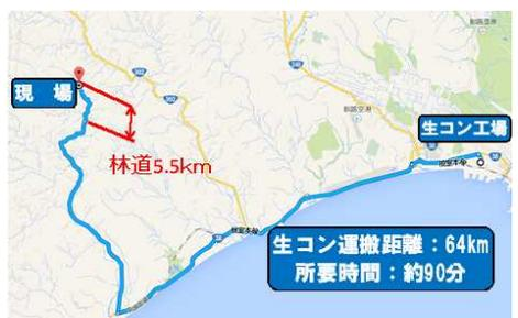
図 3.3.1 生コン車の運搬経路
