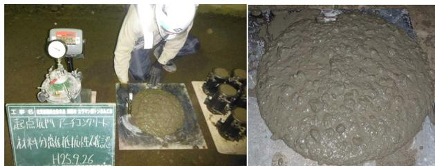
写真 3.1.1 材料分離抵抗性の確認
