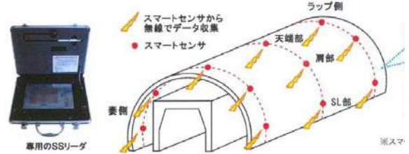
図-7 スマートセンサ型枠システム
